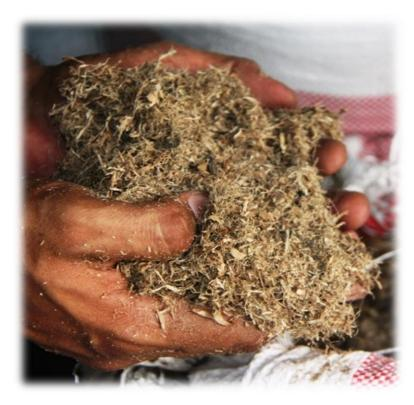
material para atender fugas y derrames de hidrocarburos y aceites.
