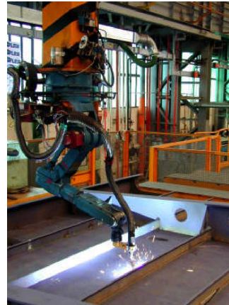
Sistema robotizado de soldadura De sub-ensambles Fincantieri Production Process Development
