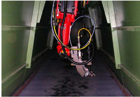
Prototipo de sistema robotizado de soldadura por laser híbrido tipo Nd-YAG (Neodimio- Y_3Al_5O_{12} ). Fuente: Fincantieri Production Process Development
