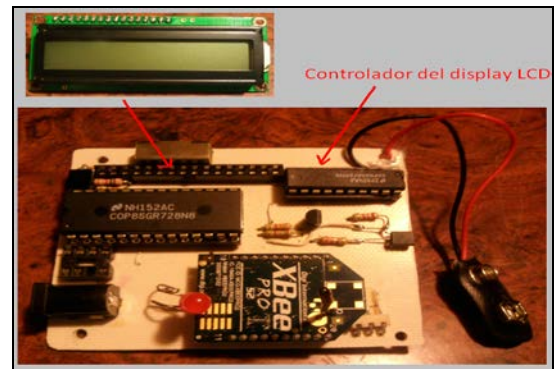
Fig. 9. Diseño del receptor para el prototipo
