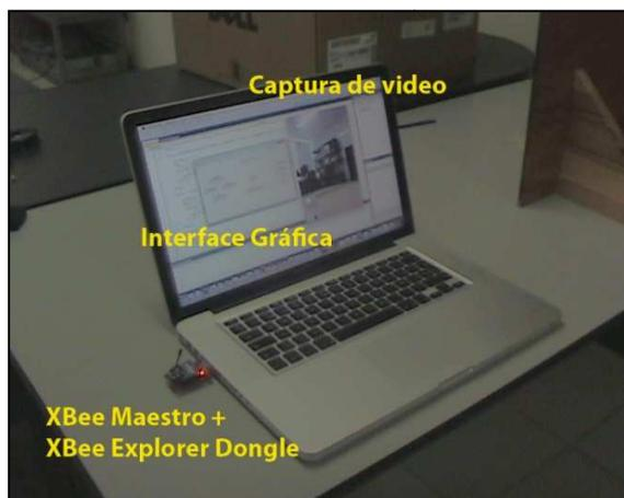
**Fig. 5** Computadora para el telecontrol del robot móvil con interfaz gráfica para la recepción de video.
