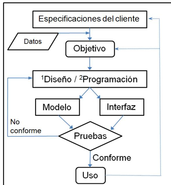
Figura 2. Diagrama de la metodología de diseño
