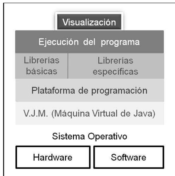
Figura 1. Arquitectura del funcionamiento de java
