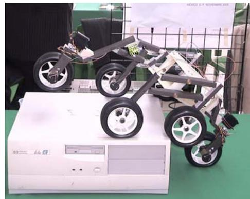
Fig.9. Robot móvil subiendo por un CPU
