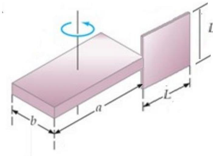
Considere que el espesor es despreciable y la placa de longitud  $L$  se une justo en la mitad de su altura con la otra placa ( $a \times b$ ) como se muestra en la figura.
