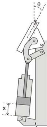
Fig. 1 Sistema del robot neumático de un grado de libertad.
