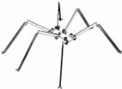
Fig. 1. Configuración del robot caminante.
